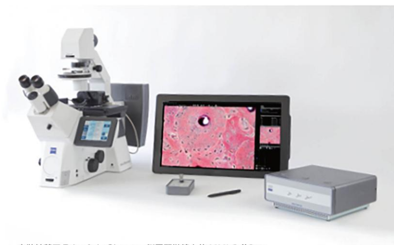
安裝於蔡司 Zeiss Axio Observer 倒置顯微鏡上的 MMI CellCut。
