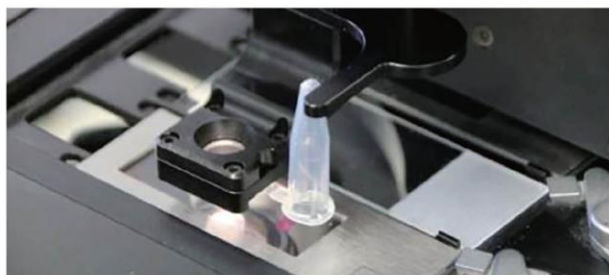
獨特的 CapLift 技術可將未受污染的目標物自動轉移至微量離心管中，並支援隨後的視覺檢查。
